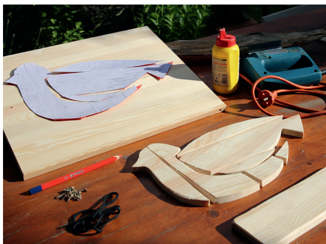
Aussägen der Taubenumrisse aus dem Leimholzbrett
